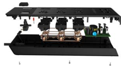
小新607采用一体式铜套设计,内阻更小、发热量更低
