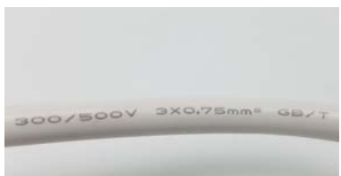
旧国标5米内10A插座的线材横截面积仅为0.75平方毫米,比新国标低了1/4
