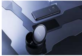
与S8系列一同发售的DeX扩展坞,可以将手机与显示器、键盘、鼠标连接,访问Dex应用程序
