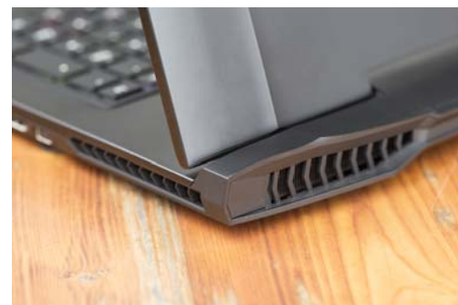
多出风口设计相对少见,但就目前我们测试过的机型来看,可以在减轻笔记本体型的情况下增强散热效率
