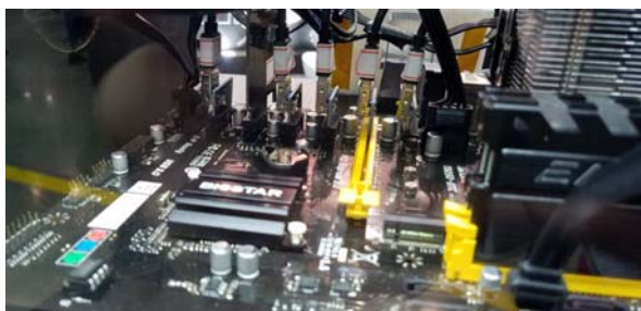
映泰的挖矿主机使用了独家开发的 PCI-E X1 转 USB 转 PCI-E X16 的转接线
