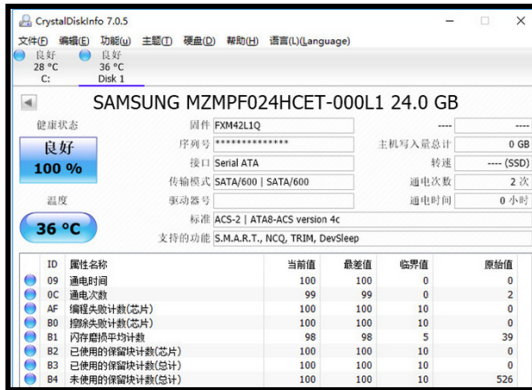
通电方面的数据没问题,但闪存磨损率有问题
