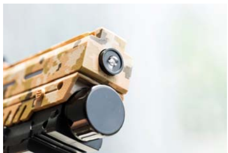
枪口处的光学定位单元，与接收器配合完成瞄准定位
