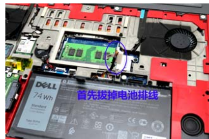
换屏第一步，掀开底盖松开电池排线
