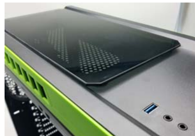
塞恩5的顶部和前面板上都加装了钢化玻璃板,巧妙地构成了风道出口
