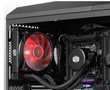
一体式水冷散热器的吸热端体积较小,安装适应度高
