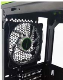
豪华版标配了3个LED灯风扇,用户可以根据自己需要改变安装位置
