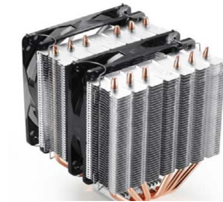
多风扇叠加,风压风量有一定提升,但实际效果不明显
