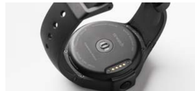
背部分布着充电触点以及心率传感器
