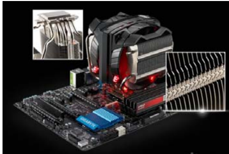
超大风冷散热器对于机箱的高度 / 宽度有要求
