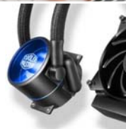
一体式水冷可以看成热管风冷的“水泵推动加强版”
