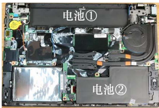
ThinkPad T450s 笔记本内置有两块电池,其中电池 1 外置可以方便拆解和替换
