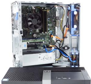
让硬盘位框架前移,进而缩短了机箱长度节省空间,再采用开门式设计来满足全面维护的需求,一举两得
