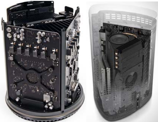
与 Mac Pro 一样,惠普 Pavilion Wave 也是三块主板形成三面体。中间夹着扬声器单元,就是这样极致的空间利用艺术,让小体积品牌机也有了高配置和大音量的底气
