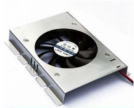
看点:可以安装在硬盘背面,对电路板区域降温
