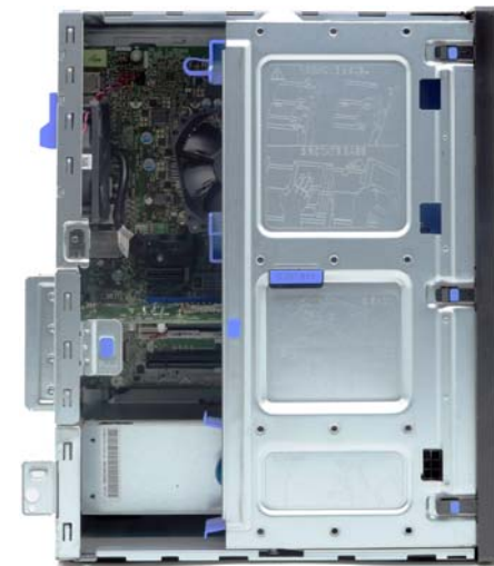
免工具拆解侧面板,打开后可以看到内面板上详细标示了如何进一步拆解的步骤,很人性化
