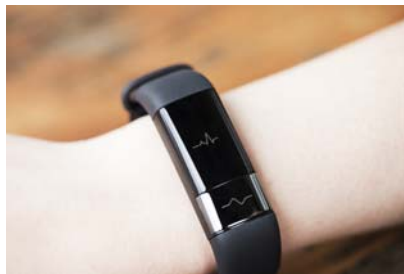
采用了 0.42 英寸 OLED 显示屏,屏幕下方为触摸电极片
