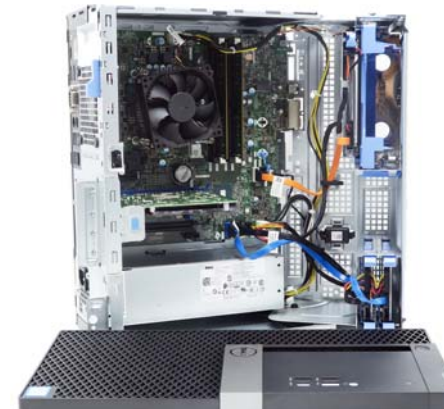
免工具拆解侧面板,打开后可以看到内面板上详细标示了如何进一步拆解的步骤,很人性化
