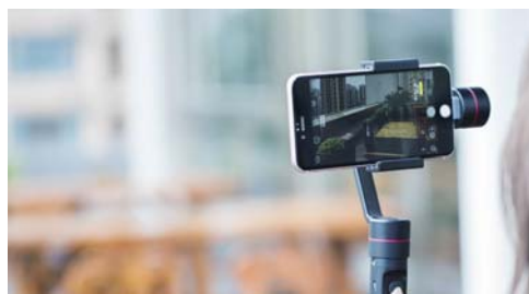
稳定器背夹可以90度旋转，横向视频拍摄和直播轻松切换
