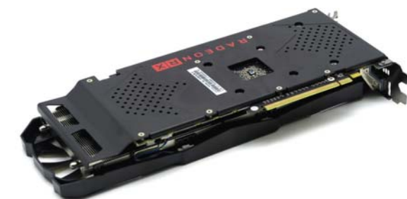
显卡背面采用了全尺寸金属背板,让显卡更牢固且可以辅助散热
