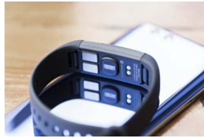
磁吸式充电触点、光电式连续心率传感器、不锈钢电极片均集中在手环背部
