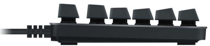
ROMER-G 机械轴的触发力度仅 45g,触发行程甚至只有 1.5mm,敲击感舒适准确且不像其他机械轴那样吵闹
