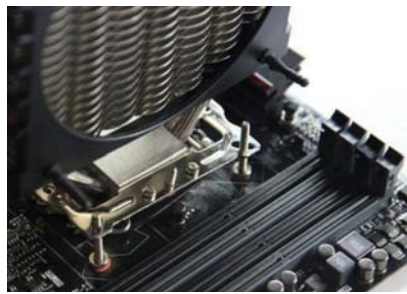
用螺丝固定的散热器如果时间长了有松动, 只需要多拧几下螺丝即可解决
