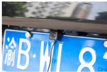
后置摄像头安装时要注意先调整好角度后再固定
