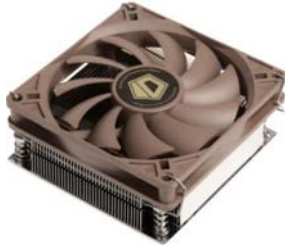
扁平的直吹式散热器适合空间狭窄的机箱,特别是电源在处理器正上方的设计
