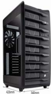
立式双层迷你机箱其实就是把中塔机箱多出来的高度换成了宽度,实现硬件与电源/存储分区独立
