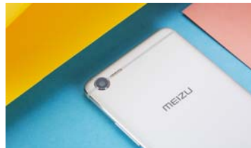
闪光灯与天线条完全保持平整,4-LED亮度也更高,被移到左上角的摄像头有轻微凸起
