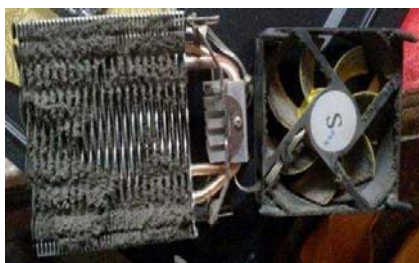
积灰堵塞了散热风道, 散热效果怎么可能好
