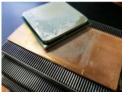
干掉的硅脂会成为散热的阻碍, 需要清理干净之后重新涂抹
