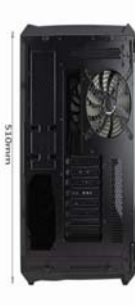
立式双层迷你机箱其实就是把中塔机箱多出来的高度换成了宽度,实现硬件与电源/存储分区独立
