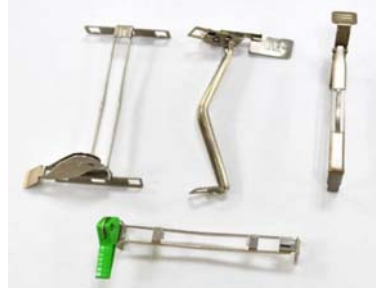
如果散热器扣具用太久, 可能会出现变形扣不紧, 用钳子稍微扳一下就好
