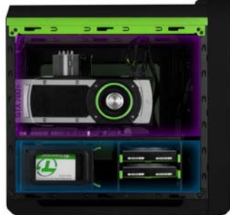
卧式双层迷你机箱中,硬件部分是平置的,超重显卡和散热器更加安全
