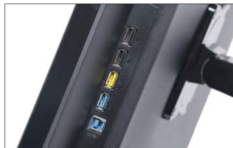
显示器左侧的USB接口，其中黄色的USB 3.0接口支持快充
