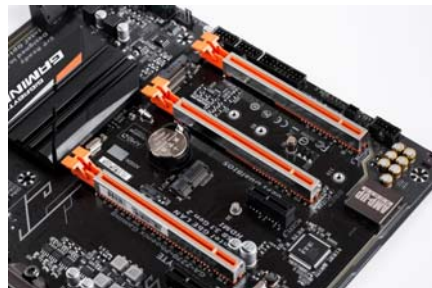
三条显卡插槽全部经过合金装甲加固,使用超重显卡毫无压力
