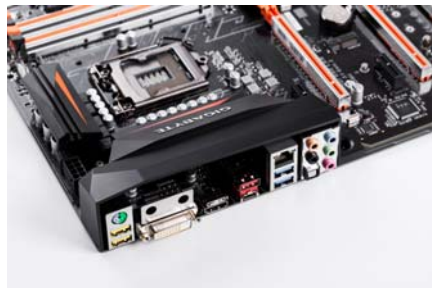
双 USB 3.1 Gen2(包含 1 个 Type-C 接口)提供超高传输速度
