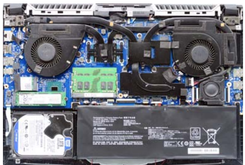
Dino 采用了掀底盖维护的方式,比较方便,内部做工还不错,但没有预留升级空间
