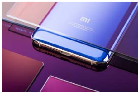
砍掉了3.5mm音频接头,仅保留USB Type-C,为了防水,开孔都做了防水处理
