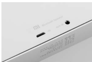
充电口为标准的MicroUSB,在支持蓝牙的情况下依然配备了3.5mm音频接口
