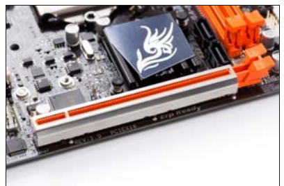
板载全长PCI-E 3.0×16插槽,并通过金属装甲加固,支持超重独显
