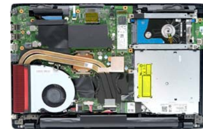
▲内部设计规整,但风格比较老旧,留有一个内存插槽可升级,散热规格不高
