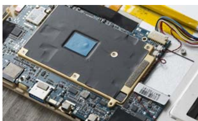
无风扇设计且散热效果出色,还预留M.2 SSD升级位,机身采用金属材质打造……2000元的笔记本也能做到
