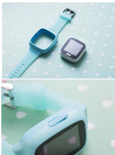
SE 2 Plus采用了一体式的嵌套可拆卸式设计,使其还具有IP65防水等级,不用担心汗渍和水迹
