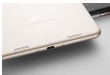
充电/数据接口为USB Type-C,扬声器位于机身背部,平放时音量会有一定衰减
