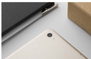
配备了1300万像素后置摄像头,旁边及机身中部的小孔为降噪麦克风
