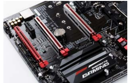
显卡插槽使用合金装甲加固,耐用度大幅提升
