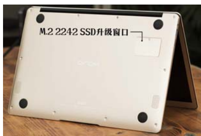
底部预留了一个小盖板, 打开后可升级 M.2 2242 SSD, 而整个底盖也只需拧下螺丝就能打开维护, 很方便
