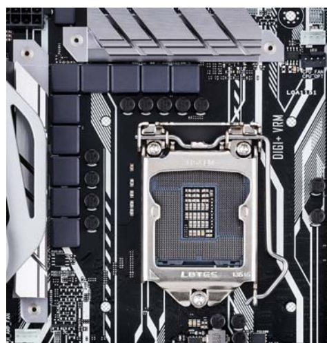
数字供电设计可以降低电路元件的损耗,让主板更加耐用
