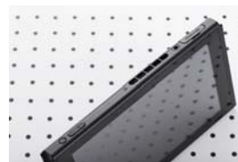
机身顶部的风扇散热口和游戏卡槽
