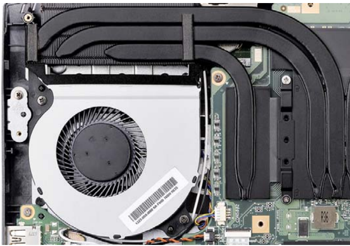
同样是三热管,一般设计只能全都挤在一起进行散热,而多一个出风口就可以将数根热管分开,明显提升散热效率
