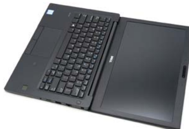
最好的轻微弧面凹陷商用键盘(带有可长亮的白色背光,两档可调),确保了文字输入的舒适性——这对办公和商业用户来说太重要了,也是高端商用本的核心竞争力之一。另外,该机屏幕可180°开启,方便演示
