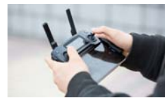
可折叠的遥控器便于携带,甚至无人机还可以支持直接使用手机进行操控
