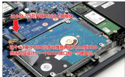
该机“阉割了”可玩性——HDD 位本可设计成堆叠两个 HDD, 但该机仅设计了一个 SATA 接口, 只能安装一块 HDD
