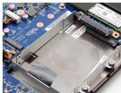
ST-Pro 标配 512GB M.2 SATA SSD,除此之外它还预留了 1 个 M.2 插槽,可升级第二块 SSD 或 3G/4G 模块。另外,该机的 HDD 位可以升级两块 2.5 英寸的 7mm HDD(堆叠)——注意,主板正反面各自有一个 SATA 接口——在可玩性上,ST-Pro 得到了最大限度的发挥
