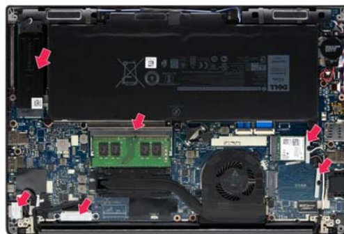
Latitude 7280的内部,设计做工规整,无任何飞线,而且做散热维护也非常方便。东芝的PCI-E SSD(左上角)被金属片覆盖着,既肃穆,也起到了电磁屏蔽的作用,能够有效保护SSD里的数据。另外,该机的牢固性设计也非常多
