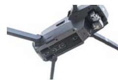
机身下方分布了超声波和视觉传感器,金属格栅的设计方便机体散热
