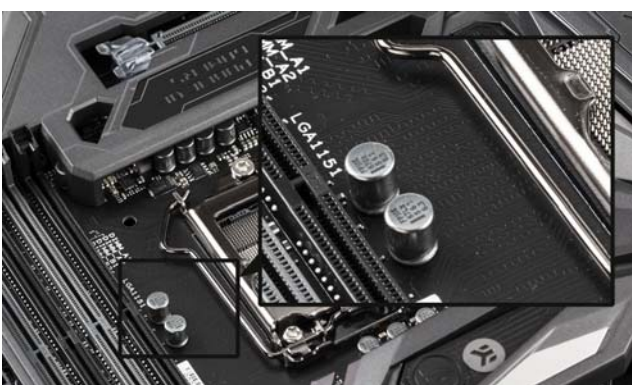
精美的蛇形布线确保内存工作高度稳定, 它与高端的电气元件, 是高品质主板的外在表现
