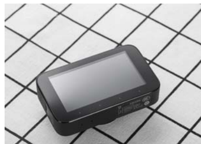
3英寸320×240屏幕,显示效果够用,下方有4个触控点,用于操作与设置
