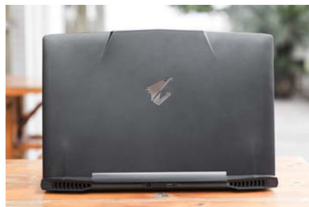
机身包括底盖都采用金属材质打造, 耐用性给力, 顶盖的Aorus“雕牌”LOGO还支持背光显示
