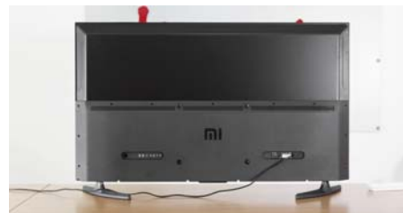
机身的背面采用了大面积的塑料材质,边框部分采用了金属材料
