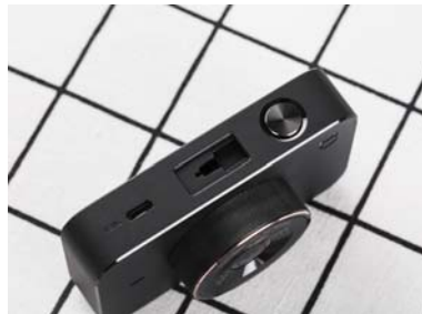
电源、接口、MicroUSB接口全部集中在机身上方,方便走线与日常操作
