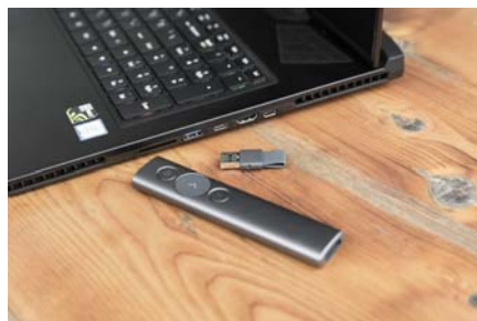
支持2.4GHz的USB接收器和蓝牙4.0两种连接方式,接收器可以内置在演示翻页笔中携带
