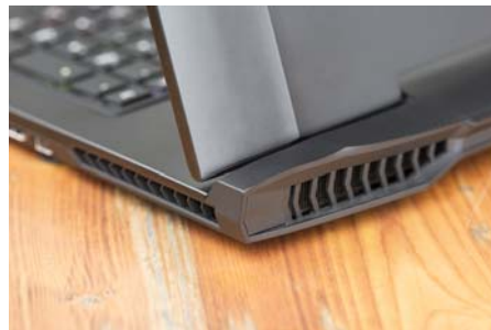
虽然薄, 但机器的散热设计很出色, 左右两侧各开了2个散热出风口, 热管分布更均匀
