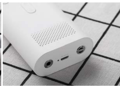
底部左侧为3.5mm耳机接口,中间为MicroUSB接口,右侧为挂绳位
