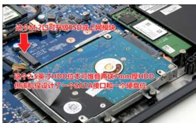
该机HDD位本可设计成堆叠两个HDD, 但该机仅设计了一个SATA接口, 只能安装一块HDD, 可玩性没有完全发挥出来
