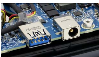
该机的电源接口只有主板的限位和焊点固定, 所以大家使用的时候要避免电源线过度拉扯
