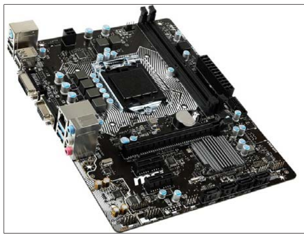
像这种 H110 只提供 1 个 PCI-E × 16 插槽的主板,装了显卡之后就装不了 PCI-E SSD 了
