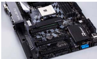
板载240GB M.2固态硬盘(可选),并加装了碳纤维材质散热模组
