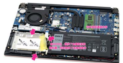
内部整体图,设计规范。可靠性设计也很多:WiFi模块天线位被塑料套压住;USB接口被主板凹槽和外壳模具上的凸起限位,固定得很紧。2.5英寸硬盘位的升级配套非常全面
