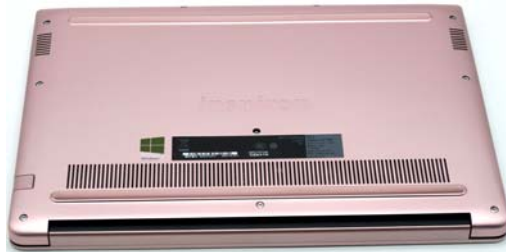
该机的底盖也是粉色的,而且靠近转轴一侧的三颗螺丝带有防脱落设计
