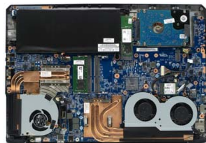
三风扇五热管, 确保了该机的良好散热。另外内部还有额外的M.2 SSD位和内存位
