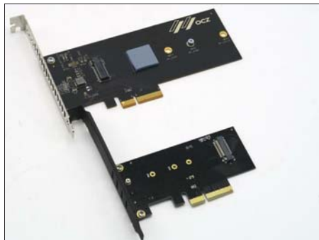
两款转接卡的对比,上为饥饿鲨 RD400 的原装转接卡,下为佳翼 SK4,原厂转接卡还是胜出一筹
