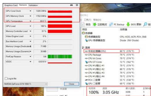
▲室温 19°C 时的考机情况,该机散热靠谱,CPU 温度 80°C,频率 3.05GHz,GPU 温度 69°C,频率 1328.5MHz
