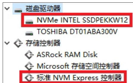
迁移完后可以看到 Intel 600P 被系统准确识别为 NVMe 设备
