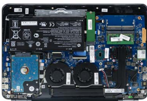
▲内部设计规整,双胞胎风扇串联式散热,电池容量 63.3Wh,在国际品牌的游戏本中容量倒是不算大的
