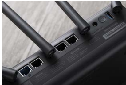
配备了1个USB 3.0及3个10/100/1000Mbps自适应LAN口,完全能够满足家用需求
