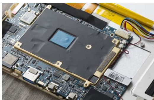
Core M 处理器无风扇设计,主板右侧还预留了一个 M.2 2242 SSD 升级位,这算是此类二合一产品中很少见的设计了
