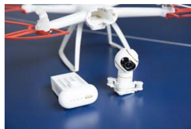
电池、云台相机、螺旋桨等都是可拆卸式的,方便携带与日后升级
