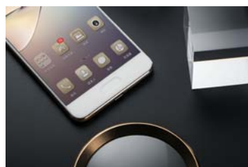
指纹识别采用了“挖槽”设计(没有打穿),好处是与前面板不会产生色差,依然是电容式方案,同时也支持轻触返回
