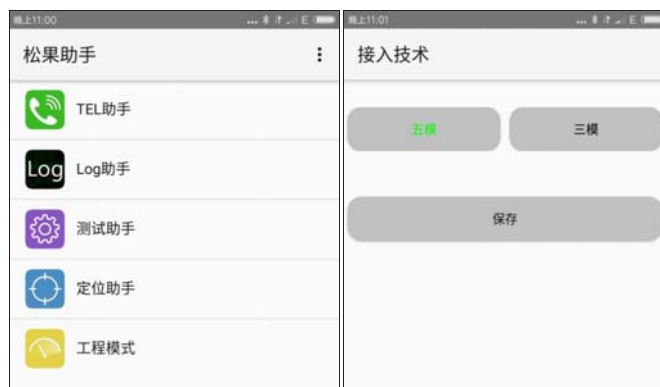
虽然官方宣称仅支持移动4G,但手动开启五模之后,小米5c即可解锁联通4G网络
