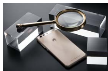
徕卡双摄区域玻璃贴片覆盖,并与顶部 U 型天线融为一体,底部天线也有一定的隐藏性
