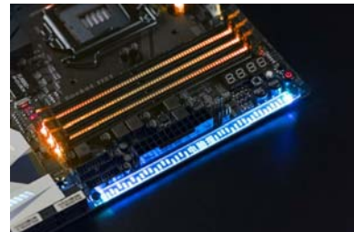
AORUS Z270X-Gaming 9 主板上的可更换式镭射雕刻导光条效果图
