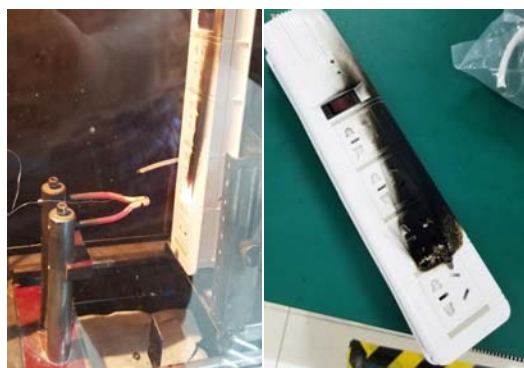
突破TZ-C0721K4在离开灼热丝后保持明火燃烧
