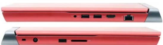
该机接口丰富,而且有HDMI 2.0接口,能够应对4K@60Hz输出,接口全部后置,不干扰用户使用
