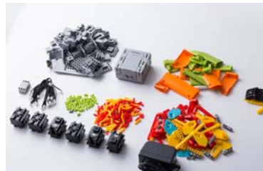
344个零件组成了机器人的机身,六个舵机负责机器人的运动处理
