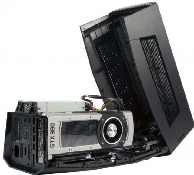
外置显卡盒基本上就是功能模块化的最强表现了,它让笔记本的轻薄和高性能得到了全面兼容
