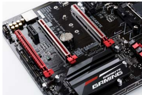
双显卡插槽均进行了合金装甲加固,耐用度和可靠度大幅提升
