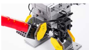
机体正上方的控制模块是机器人的大脑,里面分布着电池和处理单元
