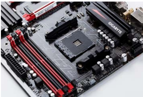
AB350-Gaming3 可以使用大部分老款散热器而不用换扣具,轻松实现平滑升级
