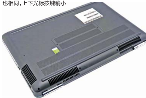
▲升级内存简单,拧松两颗螺丝,拆下中间的盖板即可。该机有三个出风口,两个在后部,一个在左侧,左侧有音频接口和一个 USB 接口
