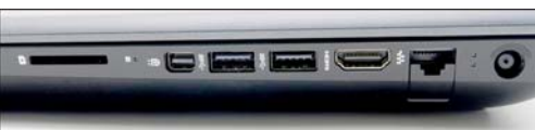
▲右侧接口,有 Mini DP 是关键,可以外接 4K 屏玩游戏,发挥 GTX 1070 的最大威力
