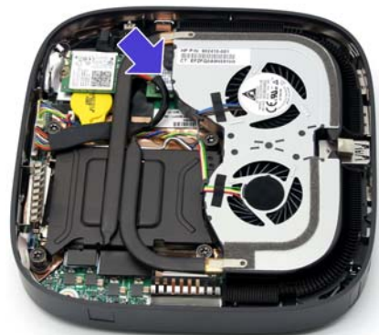
目前销售的i3/i5款没标配SSD，自行添加时要拆解主机。拆解很简单，“三明治”结构，拧松螺丝就能分离出来。不过，要添加M.2接口SSD需要取下整个散热组件——M.2接口SSD位是被压在下面的
