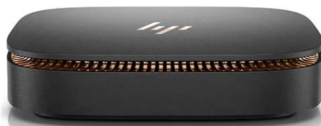
Slice主机（官方称为“面板”）的周围金黄色一圈是散热槽，内置双风扇，能以低转速低噪音将热量快速排出主机。主机的顶配版也就1kg重
