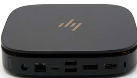
Slice的视频接口丰富，还有双USB Type-C口用于扩展（有一个在侧面），结合桌面处理器，多屏扩展能力出色——这也是该机定义为Elite系列的原因之一。不过两个标准USB口少了点，另外，没有SD读卡器也是遗憾
