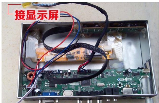
进阶版的信号驱动电路板带有丰富的接口,实用性更高。图中电路板上方的高压板,用于给LCD显示屏额外供电的
