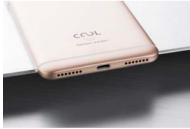
手机底部是Type-C接口和扬声器开孔,同时也可以看到手机的厚度比较适中
