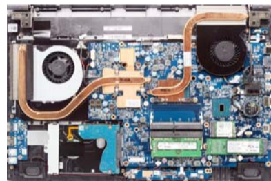
ST-Plus 采用外置电池设计,开盖前可以先取下来。该机的内部设计还算不错,处理器和显卡采用分离式散热设计,右侧出风的是 GTX 1050Ti,除此之外预留了 1 个内存插槽,清灰维护算是比较容易了
