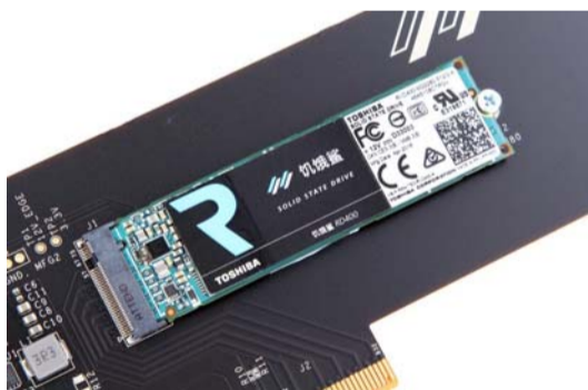
饥饿鲨 RD400 其实就是安装在扩展卡上的 M.2 接口 SSD,既可以拆下安装在 M.2 接口上,也可以直接插到 PCI-E 插槽上
