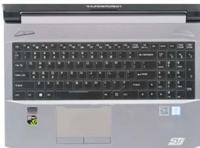
ST-Plus 的输入手感中规中矩,触控板左右键面积较小且手感偏硬,键盘背光可三区多彩独立设定,比较有个性。因为散热出风口在右侧,所以考机时热量集中在数字键盘区,尤其是“+”键附近
