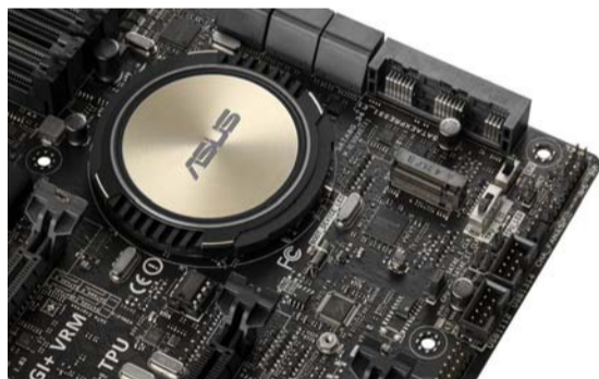
华硕 Z97-Deluxe 上的 M.2 接口带宽只有 10Gbps,不适合读写速度在 1000MB/s 以上的 M.2 接口 SSD
