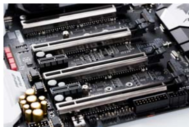
显卡插槽配备了合金装甲和金属加强锁，插超重显卡更加安全
