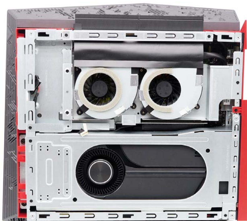
这就是G20CI的内部啦,用密不透风来形容也不为过,可以看到显卡是横置设计,出风口朝向机身背部,而处理器则采用两个风扇+热管来进行导热,出风口方向朝上
