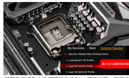
仅需在 BIOS 中选择预设的 5GHz 超频档案, 即可实现一键超频 5GHz
