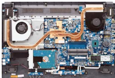
蓝天 N870HK 是一款 17.3 英寸本,可以看到在搭载 Core i7 7700HQ+GTX 1050Ti 的情况下,内部还是有大量的闲置空间,因此 15.6 英寸甚至更小尺寸的产品设计难度其实并不大
