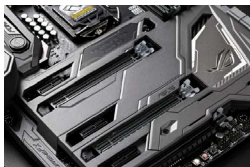
金属外壳强化后的 Safeslot 插槽, 在立式机箱中安装超重显卡毫无压力
