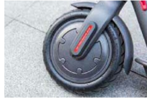
前轮内置250W无刷直流电机，8.5英寸的轮胎也提供了对路面更好的适应性
