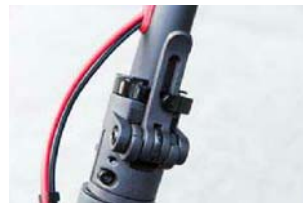
把立上的折叠关节安全扣锁定很稳，转向时不会感觉到任何松动
