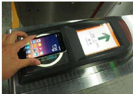
用手机刷地铁时，将NFC线圈与刷卡器的线圈对好，才能触发地铁和公交的刷卡器
