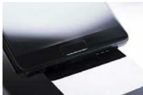
前置指纹模块在正面玻璃之下,摸起来是完全平整的,周围的金属包围圈依然可见
