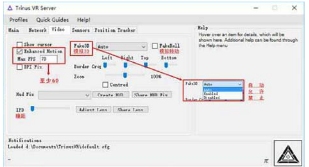
帧速设置在60fps以上,模拟3D可设为自动,瞳距根据自己需求调整
