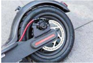
后轮上的通风式碟刹和前轮的能源再生制动配合，组成双重刹车系统
