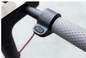
线性油门采用了按压式扳手设计，同时握把的防滑垫触感也比较舒适
