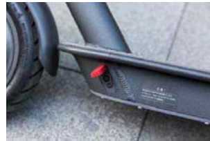
电池仓位于踏板下方，在一定程度上降低了底盘高度，但也让车身重心更稳。电池仓左前方是充电口，胶盖十分紧密，防水效果不错
