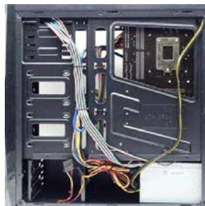
打开另一侧面侧板,可以看到电源采用的是独立风道的下置设计,3.5 英寸 HDD 安装位则在左下方,供电线也已经放在那里了
