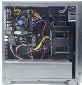
独显需要玩家自行安装,这也大幅减少了运输过程中造成损坏的可能,而且机箱背板已经开好了槽,6pin 显卡供电也放在旁边,基本上是伸手就来
