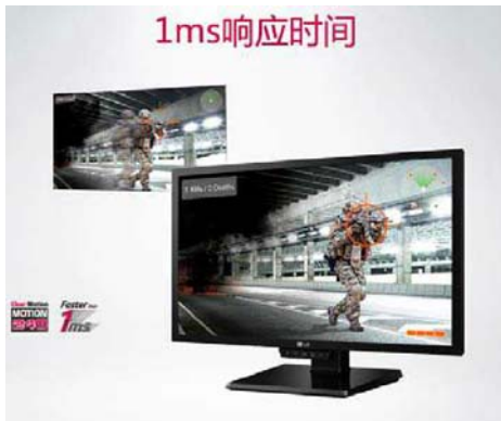
响应速度快是 TN 面板的优势,这类显示器最快能达到 1ms 响应时间
