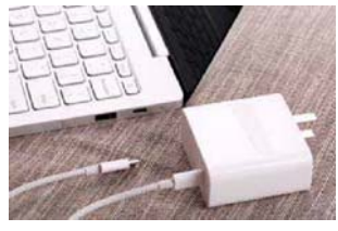
充电器采用了可折叠的便携式设计,笔记本边缘的 Type-C 接口兼备充电和数据交换功能,也可以给 Type-C 接口的手机充电
