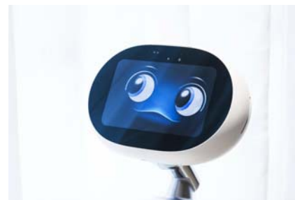
小布的脸是一块支持10点触控的屏幕,上面还有很多传感器
