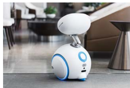
颈部坚固而灵活的关节让小布的头部能做出许多生动的动作
