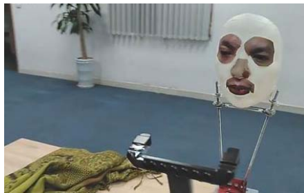
越南安全公司 Bkav 用 3D 打印面具解锁 Face ID
