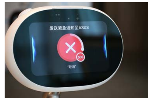
连拍4下小布的头,或是大喊“救命”,小布就能将SOS信息发送至绑定的手机
