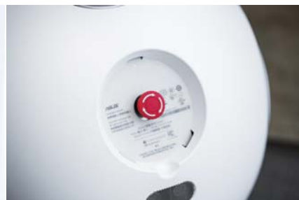
紧急开关同时也是小布的电源开关
