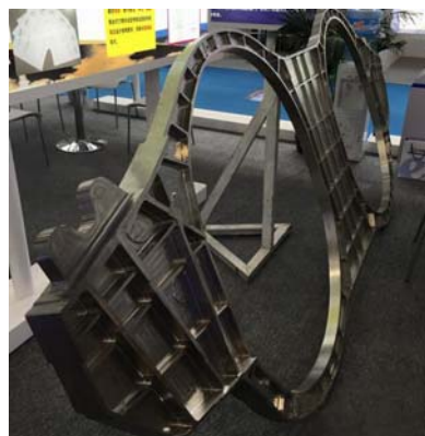
3D 打印的战斗机主框架结构
