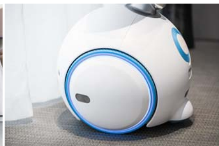
可独立旋转的驱动轮让小布可以实现原地转向的灵活动作
