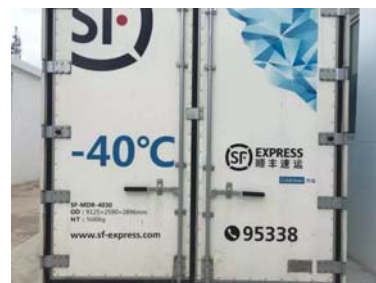
顺丰可制冷-40°C的移动急冻柜
