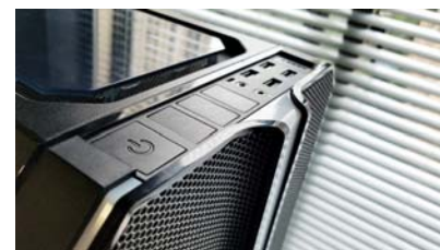
顶部按键可以对RGB灯效和风扇转速实现一键控制
