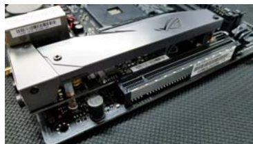
双层结构巧妙地解决了 M.2 插槽 / 声卡的布线并与主板芯片实现隔离散热
