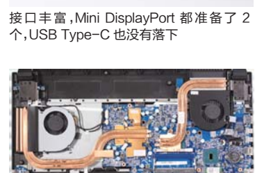
只需拧下底部螺丝就可打开进行清灰等维护,十分方便。内部还预留了 1 个内存插槽和 1 个 2.5 英寸 SATA 安装位,可升级空间不错
