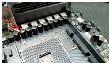
虽是迷你主板,但 7 相 Digi+ 数字供电依然强悍,堪比豪华大板
