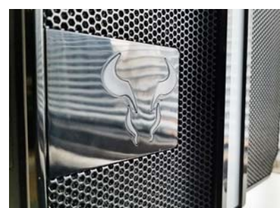
前面板采用蜂窝网状设计,并附加防尘网,既保证了足够的通风散热效果,又能充分防尘
