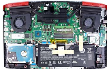
宏碁暗影骑士3 GTX 1050版内部是这个样子,飞线和胶布密布,很多地方感觉都不太可靠。而且5299元还买不到无短板配置
