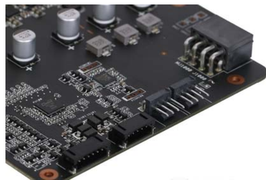
显卡上提供风扇接口,风扇转速就能随 GPU 温度变化
