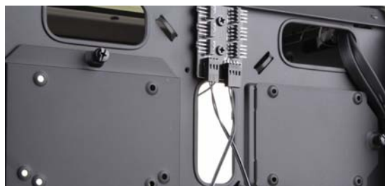
安钛克 CUBE 机箱自带的风扇集线器
