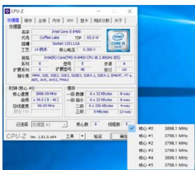
Core i5 8400的6个核心可同时睿频到3.8GHz~3.9GHz
