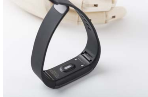
背面有2个充电用的磁吸式金属触点以及PPG心率传感器
