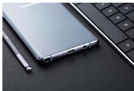
所有开孔都没有特别的防护措施,即便如此依然做到了IP68级的防尘防水,可见Note8内部结构多么紧凑
