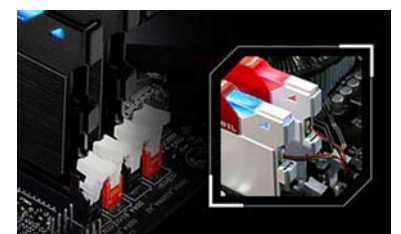
部分品牌的灯条需要外接供电线或控制线才能工作
