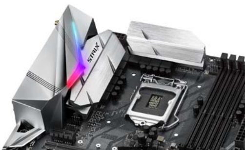
雕刻了武士斜纹的酷冷银色散热片, 不但尽显猛禽风格, 还为提供强大电流的 MOS 管打造了出色的散热环境
