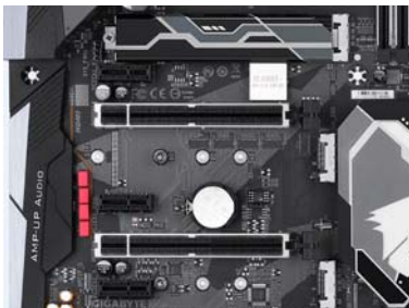
3 条 M.2 插槽全部支持 32Gbps 带宽,并可以打造 RAID 系统提供超高传输速度
