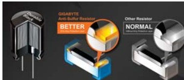
黑金固态电容和抗硫化电阻有效提升主板使用寿命
