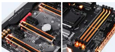
显卡和内存插槽均使用合金装甲加固,抗物理冲击能力大大增强
