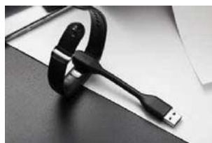
采用了流行的吸附式充电接口，常用的手机充电底座或USB插线板都可以为其充电
