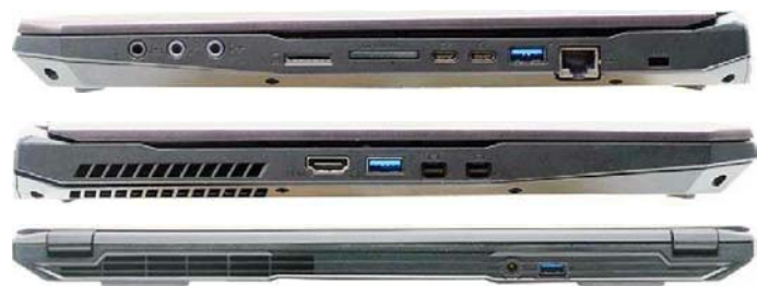
接口三面布局且种类齐全,USB3.1 Type-C Gen 2、Mini DP、HDMI、S/PDIF 输出……
