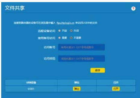
外接USB存储设备后,无线路由器变身简易NAS
