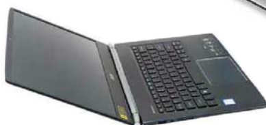
SF514的体型较为小巧,铝合金C壳和镁合金机身设计让它的耐用性也达到了较高水准
