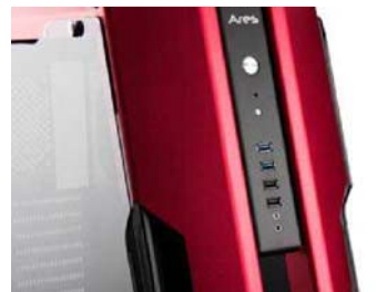
机箱前面板和顶盖采用的铝合金板材厚度达到了3mm,相当厚重扎实
