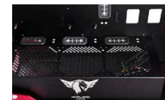
全长独立电源仓很好地隔离了散热区域,并且还可以安装360mm水冷散热器
