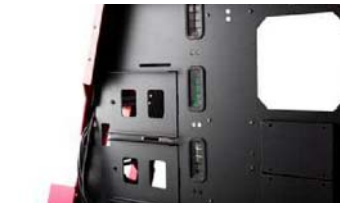
背线空间深达40mm,没什么粗线、硬线排不下的,理线更轻松
