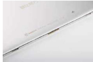
平板底部的金属触点保证了主机和键盘的数据链接,两侧的开孔很好地固定了键盘
