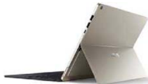
该机有USB口、HDMI口和雷电(Type-C)口,不过后者同时也是电源接口,所以若要连接扩展坞,必须是带有“反向充电功能”的扩展坞
