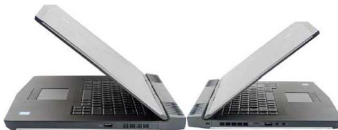
因为转轴前移的关系,Alienware 15 的后部也能设计接口了,从而解放了左右两侧,甚至左侧设计了一个出风口,右侧设计了一个进风口。除此之外后部也全都是一旦使用就不会经常拔插的接口,便于桌面布局
