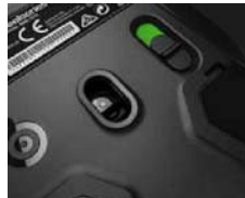
底部提供了侧边按键硬开关,一键切换 FPS/MMO 模式
