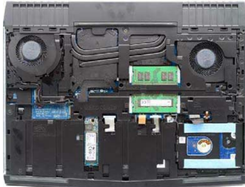
拧下数颗螺丝就能轻松打开 Alienware 15 的底盖,它采用了内部防滚架设计,裸露在外的只有各种接口和线材而已,内部做工相当扎实,散热采用的是三热管双风扇,为风扇清灰需要拆下防滚架,而且它只有 2 个内存插槽,所以可升级的地方就只有 SSD 了
