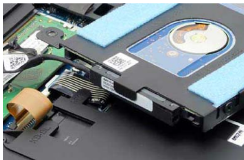
2.5 英寸硬盘托架虽然不至于像顶级工作站那样采用全包围的金属盒,但也相当贴心地为接口进行固定设计,这样一来就完全无惧线材脱落了
