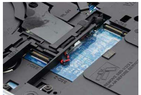
裸露在外的两个 SSD 接口,分别对应 M.2 2280 和 M.2 2242, Alienware 15 的 2 个 M.2 2280 都同时支持 SATA 和 NVMe PCI-E 总线,而下方露出的 PCB 板也采用了塑料膜进行覆盖以防静电,这也算是高端本独有的设计了
