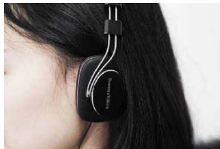
打开磁吸式耳罩即可更换线材,吸附的力度刚好,既保证不会掉落又不会难以打开
