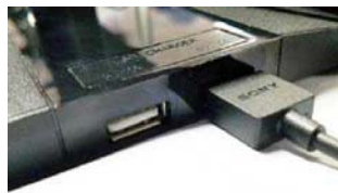
显示器上独立供电的USB接口,与主板隔绝,随便你怎么用
