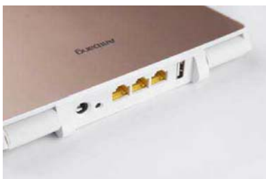
无线路由器背面的USB接口一般是用来连接移动存储设备
