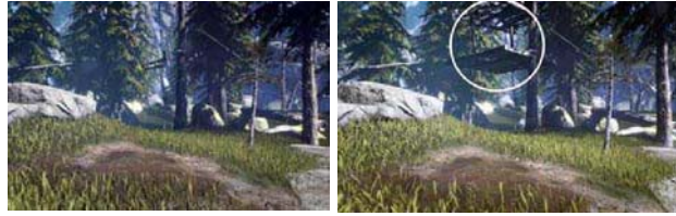
看出区别了么?《古墓丽影:崛起》这款游戏的 Benchmark 有一个特性,就是不会第一时间渲染画面显示的全部材质,必须要镜头拉近之后才给予显示,在视野进行到相同位置时,3GB 版(左图)压根儿就没有把应该渲染的木质高台给渲染出来,6GB 版已经开始渲染了。3GB 版必须拉到很近才会开始渲染,而这种降低工作量的做法自然会令 3GB 版的实时帧速明显更高,所以虽然帧速看起来还不错,但实际体验却变糟糕了
