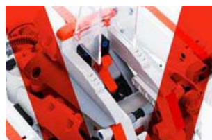
顶部驾驶舱打开之后,里面就是智能控制单元的电源开关,按下是开,再长按就是关
