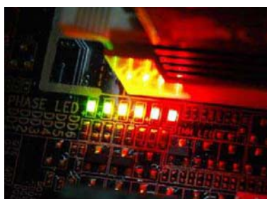
显示处理器当前供电相数的LED灯光系统，主要作用是炫技
