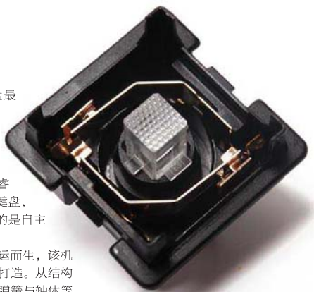
机械轴内部,其采用了双触发机构的设计,使用寿命更长
