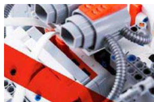
腿部电机通过两条USB Type-C数据线与控制单元连接
