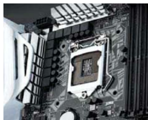
有 10 相数字供电的 Z170 主板,超频能力才靠谱
