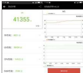
高性能电源模式下,安兔兔跑分为41355,15分钟压力测试电池温度为40°C
