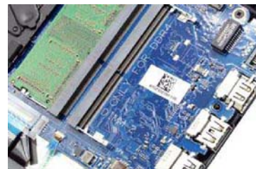
预留了一个内存插槽,并且在 PCB 板上标注了 DDR4 内存类型。除此之外该机的接口也全采用了加固设计,细节设计出色
