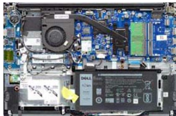
Vostro 15 5000(5568)底盖比较容易拆下,虽然是独显机型但散热依然采用单热管单风扇设计,不过就日常使用来看是足够了,还能有效降低体温
