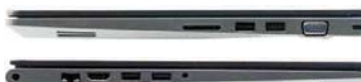
该机的接口相当也是为商用办公而设计,还标配了目前家用本上非常少见的 VGA 接口,综合来看接口类型也比较全面
