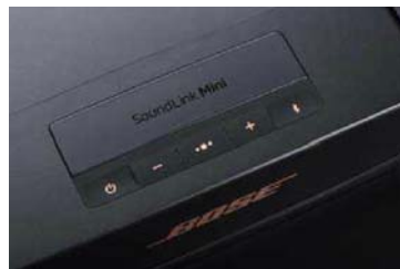
机身的按键采用了类似肤质塑料材质,手感不错,但按键反馈不太清晰
