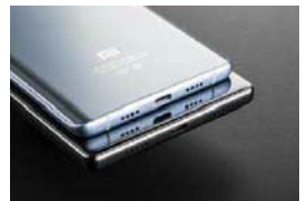
扬声器和麦克风均为对称式设计,都采用了USB Type-C接口
