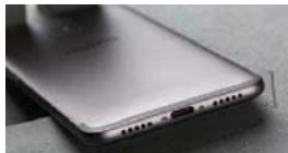
底部采用了Type-C接口,对称式开孔,感觉不到毛刺感
