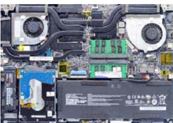
S4 很好拆,内部设计紧凑,采用双风扇、三出口、五热管设计。因为标配规格就相当高,所以就没有预留太多升级空间了
