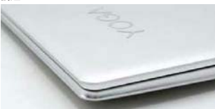
不同于A/C/D面的磨砂工艺,该机的侧面采用了金属亮拉丝工艺,使得该机不那么单调
