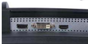
注意HDMI接口是不支持144Hz图像输入的
