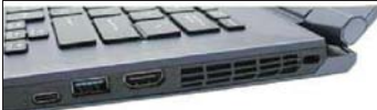
S4 相当轻薄,体重只有 2kg,但接口方面不算含糊,尤其是雷电 3 接口的配备让它的扩展性有保证
