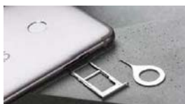
从卡槽可以看出,虽然提供了两种存储容量选择,但其依然支持TF卡扩展
