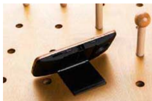
投影模块上也有一块金属支撑板,可以实现0~90°自由旋转,以适应投射时的角度需求
