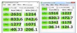
M.2固态硬盘在PCI-E 3.0 ×4(左)和PCI-E 2.0 ×4(右)平台上,性能差距比较明显
