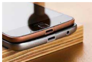
两款手机均配备了USB Type-C接口,因为机身超薄,MOTO Z(上)也取消了3.5mm耳机接口。终于加入了指纹识别模块,很少见的方形,面积也有些小
