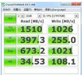
独显插槽扩展PCI-E固态硬盘,性能有保障
