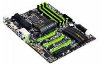
提供多个 PCI-E ×16 插槽的老主板,通过转接卡升级 M.2 固态硬盘很方便
