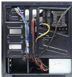
该机采用的航嘉暗夜猎手S1机箱支持背线,送到玩家手里时就已经布局完成,方便升级,而且下置式电源有独立风道设计,3个3.5英寸硬盘位预留在上图的左下角位置
