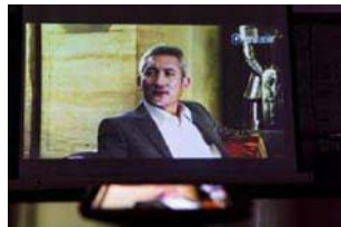
投影模块能投出最大70英寸854×480分辨率的图像,不过由于亮度只有50流明,只能在昏暗的环境下使用
