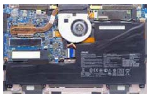
灵耀 3 的底盖很好拆,所以清灰很简单,内部非常紧凑,没有预留升级空间,单热管单风扇设计算是足够了,而且散热器叶片仅 0.3mm 厚,整个散热器仅 3mm 厚,热管管壁厚度也只有 0.1mm
