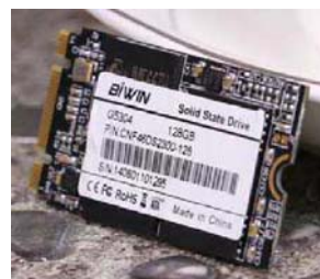
走 SATA 总线的 M.2 固态硬盘性能只与 SATA 固态硬盘相当
