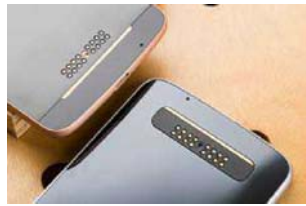
两款手机均支持所有模块,所以机身背部下方可以看到“魔磁”,也就是用于吸附模块并传输数据的接口,如果没有模块遮挡,看着还是有些打眼
