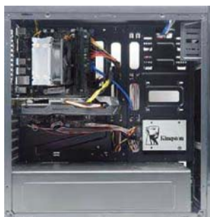
复仇者V107的内部空间比较充裕,技嘉B150M-WIND为M-ATX主板,体积小,支持单显卡,而标配的技嘉GTX 1060独显需要玩家自行安装。另外,电源连接主板的排线也要自行插上
