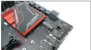
买主板时选择支持M.2接口的主板,就可升级高速M.2固态硬盘
