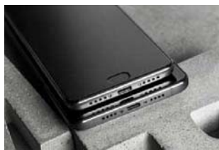
两款手机均采用了USB Type-C接口，扬声器与麦克风也是对称设计
