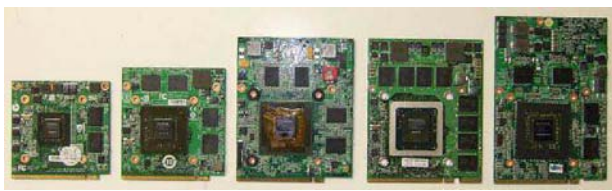
从左到右分别是MXM-I、MXM-II、MXM-III、MXM-IV与MXM-HE五种接口的笔记本独显
