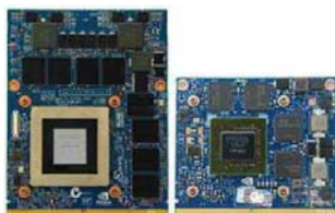
MXM-B和MXM-A显卡的实际大小及布局区别
