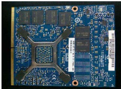
注意显卡背部的支架,通常有双面胶贴在 PCB 上,要小心拆下
