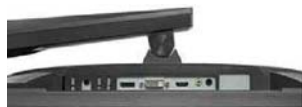
尽管某些 144Hz 显示器提供了 DVI+DisplayPort+HDMI1.4 的视频接口组合,但 HDMI1.4 线材无法传输 144Hz 刷新率图像
