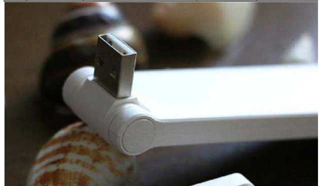
小米 WiFi 放大器通过 USB 接口供电,与手机充电器、Android 电视盒、智能电视、移动电源等设备连接都能正常工作,而且机身可以 180° 旋转,便于调整天线位置
