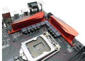
市面上销售的高配 B150,也能拥有堪比豪华 Z170 的 10 相供电
