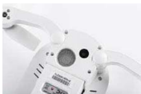
机身的下方类似摄像头的装置并不是用来拍照的,而是一个视觉光流超声波定位系统
