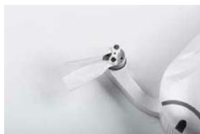
DOBBY 并没有标配护桨,无人机在坠落后桨叶极易发生断裂
