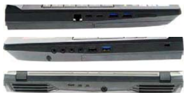
接口很全面,尤其是搭载了 3 个 USB3.1 Gen 2 接口,这属于瞄准未来高速外设的设计了。除此之外还有雷电 3 和 USB3.1 Type-C,HDMI 和 2 个 Mini DP 显示输出都在后方,音频输出也支持 S/PDIF
