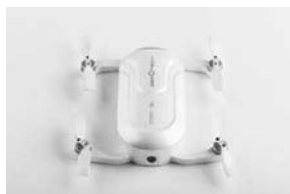
可折叠的机臂方便收纳,但在一定程度上牺牲了飞行中的稳定性
