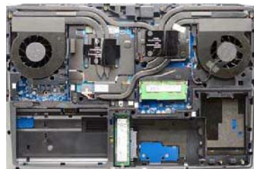
这个图是拆掉了 HDD 拍摄的。大家如果买的这个版本,是配备了 1 个 M.2 SSD,1 个 2.5 英寸 HDD 的,键盘下方还有 2 根内存插槽,共计 4 根,所以组建 64GB 内存是没问题的(每根插槽插 16GB)。除此之外 GTX 1060 是 MXM 接口的,散热器体积够大看起来够威猛
