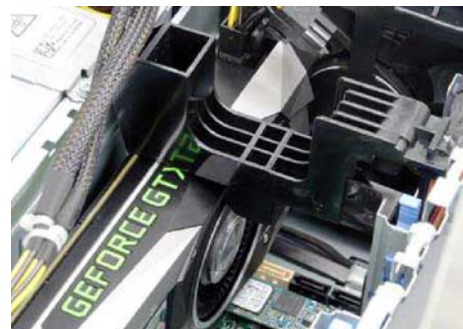
GTX 1070 有专门设计支撑架来进行辅助, 而且在拉开电源之后才能取下, 这一点很人性化——很多 DIY 机器后期无法点亮就是因为显卡没有托架, 把主板拉变形了
