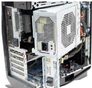
解开背板的两个锁, 就能像开门一样把电源给拉开, 这个设计相当超前, 也为节约内部空间奠定了基础
