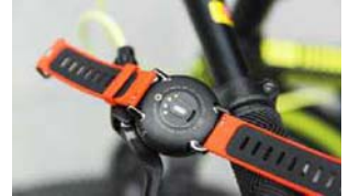
手表底部集成了心率监测功能,可以看到手表是采用触点式充电方式
