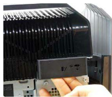
Aurora R5 的侧盖只需拧下一颗固定螺丝, 然后再如图这样一拉, 就能轻松打开了
