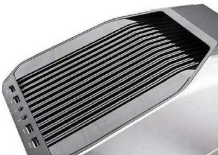
Aurora R5 的顶部是光滑的倾斜设计, 虽然好看但移动硬盘等设备无法平稳放置。除此之外水冷热排出风口朝上, 所以为了不遮挡散热空间, 尽量要放在正常高度的桌面下方
