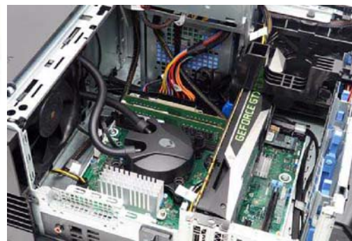
拉开电源后, Aurora R5 的内部就算是一览无余了, 可以看到该机采用的是单显卡设计(可以插第二块显卡), 处理器部分采用了水冷散热, 热排位于机身顶部, 总体来看该机内部设计算是紧密
