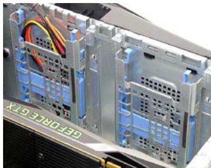
Aurora R5 在机身底部预留了 2 个 2.5 英寸硬盘位, 而且也预留了电源线数据线走到了这个位置方便进行免工具升级
