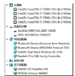
设备管理器信息,可看到 CPU、SSD、HDD、WiFi、有线网卡、显卡等信息。无线网卡是 AC3165,目前主流的 802.11ac 无线网卡,兼容性好,但信号搜索能力普通,最大无线带宽为 433Mbps
