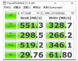
这是燃 7000 内置的 128GB 闪存 X400 SSD(M.2 接口 SATA3 总线)的性能测试截图,总体表现还算不错
