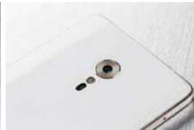
ZUK Z2 Pro 背面可见心率血氧传感器和紫外线传感器
