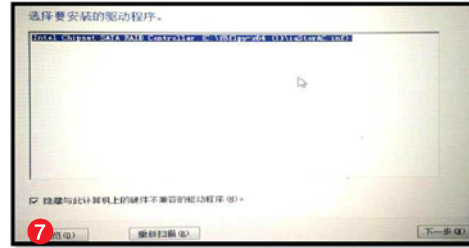
安装英特尔官方最新的磁盘驱动,这种方式具有通用性,但系统装好后还是要再次安装SSD厂商驱动
