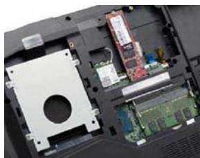
底部预留小盖板, 打开后可以升级第二M.2 SSD和内存。除此之外还有2.5英寸SATA硬盘安装位, 也正因为它占据了空间, 所以左侧才没有办法放置接口(左侧其他位置为散热器)
