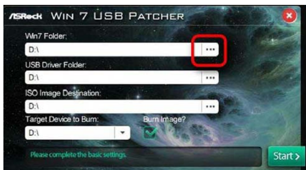
通过华擎 Win7 USB 补丁软件,可以为 Windows7 安装 U 盘打上 XHCI 驱动
