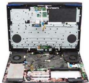
F117的拆解相当复杂, 本来以为是掀底盖, 却发现要从C壳拆起, 而且还要取下无线网卡、SSD和2.5英寸硬盘架并拧下转轴处的隐藏螺丝, 而且打开后还得取下主板才能维护散热器……
