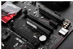
华硕B150 PRO GAMING/AURA主板标载双PCI-E 3.0插槽,显卡和SSD双兼容
