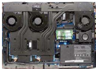
该机只需拧下全部底部螺丝就能打开底壳,倒也方便。内部最吸引眼球的就是三风扇八热管散热方案,几乎 2/3 都由巨大的散热片覆盖,实际上 P870DM 的可升级性相对而言还是受了双显卡的限制,比如它就没有预留任何的 2.5 英寸硬盘位
