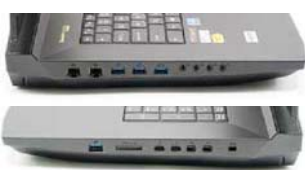
接口非常全面,5 个 USB3.0、2 个雷电 3 接口、2 个 Mini DP、2 个千兆有线网卡,还有 HDMI、7.1 声道音频……
