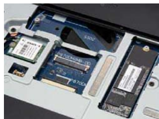
拧下底面内部键盘固定螺丝,就能撬开键盘,露出下方的升级接口,该机有 2 个 M.2 SSD 接口,已经占了一个,但遗憾的是,2 个都是 SATA 总线,一旁还能看到该机的无线网卡
