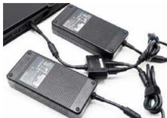
GTX 1080 SLI 光两块显卡的 TDP 就达到了 360W,再加上桌面处理器和巨大的屏幕,因此 P870DM 采用了两个巨大的 330W 适配器进行供电的方案,相信绝大多数玩家可能闻所未闻
