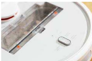
打开顶盖可以看到按键说明及WiFi连接状态,储污盒可以轻松地取下进行清洁
