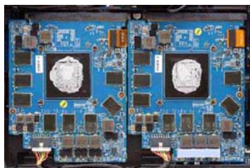
两块基于 MXM 接口的 GTX 1080 独显,两者的 SLI 桥接器也能从图中看到
