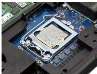
这么高的配置,必须采用桌面版处理器啊,我们测试的 P870DM 标配了 Core i7 6700,但即便是相对较低 TDP 的处理器,考机温度也可逼近 100°C!
