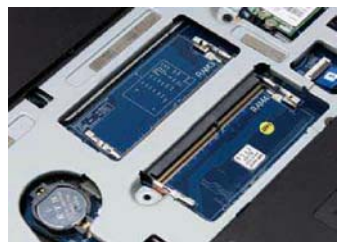
键盘下方更是预留了额外的 2 个内存插槽,也就是说 P870DM 可轻松实现 64GB 内存(4 × 16GB DDR4),这样的规格对于顶级来说算是合理合化了
