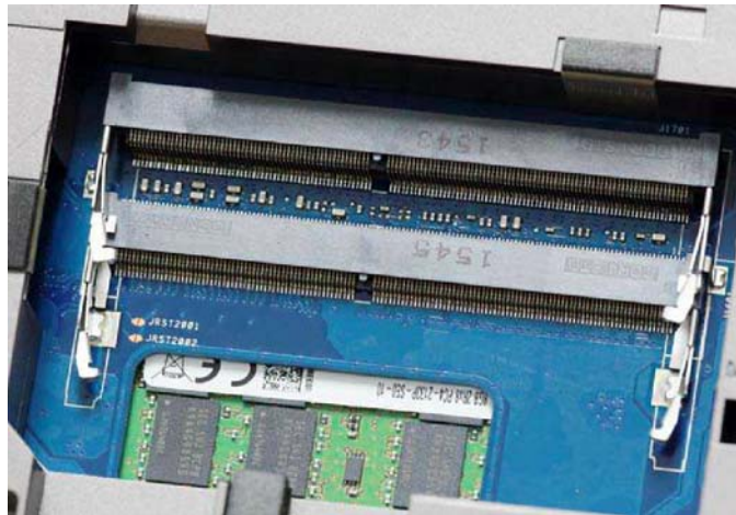
GFX72VS 总计有 4 个内存插槽,打开底部小盖板后可见到预留的其中 2 根,而且它的设计很巧妙,正好可以看到预装的内存规格贴纸,进一步提醒玩家切莫买错规格
