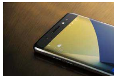
屏幕上方两侧是虹膜辨识区,红外线照明跟红外线相机,听筒旁比较大的那个才是前置摄像头
