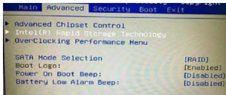
开机按 F2 进入 BIOS 后将 SATA Mode 改为 RAID 后,需要重启。重启后再次按 F2 进入 BIOS,才会出现 Intel Rapid Storage Technology 选项卡(这里是已经出现后的截图)
