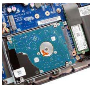
雷神 ST-Pro 比较人性化地设计了硬盘固定框架,装好后硬盘固定完好,倒放也不会跳出,至此,我们的 512GB SSD+ 双 HDD RAID 0 方案已初见雏形!
