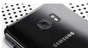
厚度有所增加的Note 7背面镜头还是没有完全抹平,补光灯下方则是心率感应器
