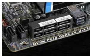
技嘉 Z170X-Designare 提供 U.2、M.2、PCI-E 三种高速 SSD 接口,还支持 RAID 0 模式
