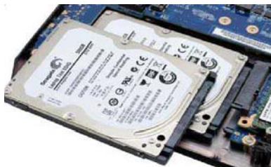
我们的测试采用了 2 块 500GB 希捷 SSHD 来组建 RAID 0,正好可以完美与雷神 ST-Pro 搭配
