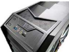
电源按键及功能接口设计在顶部斜面上,方便操作。顶部采用了类似“龙鳞”的设计,比较威武
