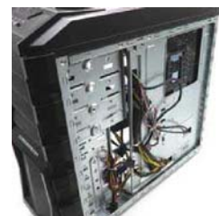
已走好背线。机箱钢板较厚,是标准的 0.8mm 板材,大部分边缘都有卷边设计,不割手
