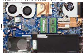
ST-Pro 很好拆,底部虽然有“撕毁保修无效”的标签,但根据我们询问雷神的情况来看,撕掉该标签只是影响 7 天无理由退换货,保修依然还是继续的!这款笔记本的内部做工颇为独特,散热为各自独立设计,显卡是图左的双风扇三热管,而处理器是右侧的单风扇双热管
