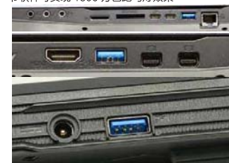
ST-Pro 的接口设计非常非常非常全面,USB 全是 3.1 版本而且总计多达 5 个,其中 2 个是 Type-C,显示输出也有 1 个 HDMI 2.0 和 2 个 Mini DP,音频输出支持 S/PDIF 功能,玩家庭影院的有福了。除此之外还标配 SIM 卡插槽可升级内置 3G/4G 模块,可玩性真的很不错
