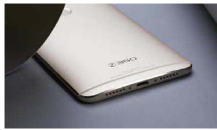
麦克风与扬声器采用了对称设计,配备了 USB Type-C 接口
