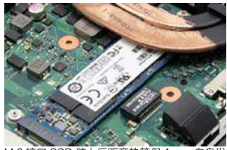
M.2 接口 SSD 装上后距离热管仅 1mm,自身发热+热管的高温,这让人心理上难以接受啊
