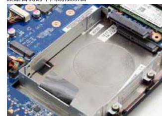
ST-Pro 标配 512GB M.2 SATA SSD,但除此之外它还预留了 2 个 SATA3 接口,可升级 2 块 7mm HDD/SSD,而且旁边还有 3G/4G 模块升级位,此位置也可升级 SATA 总线 M.2 SSD,所以可升级空间还是挺大的
