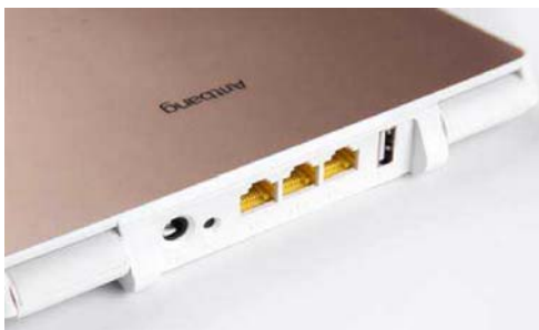
无线路由器背面的USB接口一般是用来连接移动存储设备
