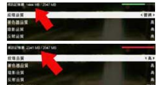
▲只是纹理材质的一档调节,显存容量直接剧增近800MB,超过了2000MB,而且其他特效还都只是“高”,要知道GTX 965M在全“非常高”特效下是可以流畅运行的!也就是说2GB显存大大限制了显卡性能!
