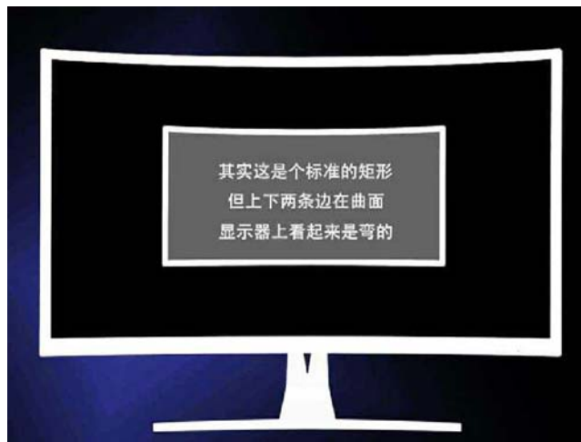
曲面带来的画面畸变是不可避免的,因此不适合精准的设计工作
