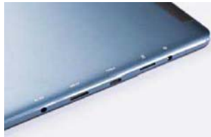
机身提供了较为丰富的接口,支持 HDMI 输出并且附赠了输出线,方便连接显示器
