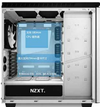
恩杰 H440机箱599元的价格并不便宜,但最大仅支持294mm的显卡,三风扇版GTX 1070都装不进去
