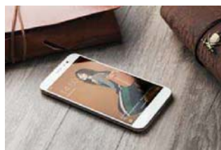
2.5D 屏和金属后盖的衔接处理得不错,边框和黑边宽度都控制较好
