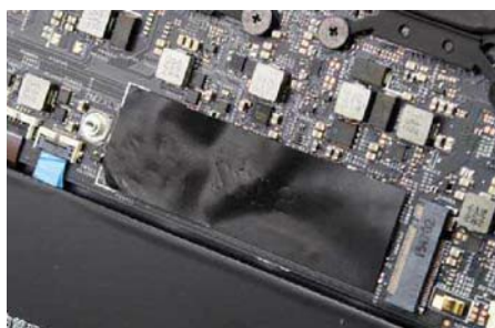
该机预留了第二 SSD 升级位,支持 2280 规格 M.2 SATA 总线接口 SSD,虽然不是 PCI-E 总线,但相对而言升级成本也便宜了不少,所以完全可以考虑 512GB 这种大容量版
