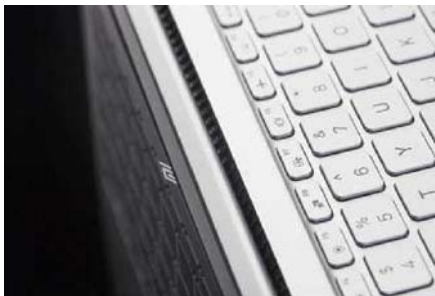
小米笔记本 Air 13.3 的出风口在屏幕打开后才会显露出来,这个设计思维是正确的,我们见过部分一线品牌轻薄本是打开屏幕开始使用的时候出风口反而被转轴挡住了,闲置状态也“铁板烧”
