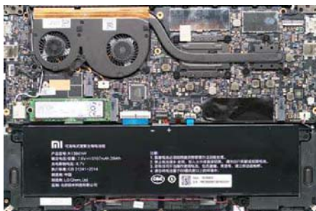
小米笔记本 Air 13.3 揭开底盖即可维护,不过底部螺丝是六角形设计,除此之外脚垫下还有隐藏螺丝需要注意。该机的内部是很典型的轻薄本设计,处理器和显卡采用单热管双风扇进行散热,而内存采用固化设计,所以单通道 8GB 就无法再升级了
