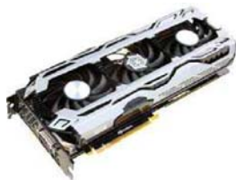
映众 GTX 1060 X3 冰龙海量版的频率为 1569MHz~1784MHz,比公版高一些
