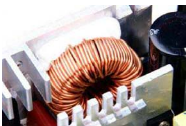
主动PFC为高端电源带来了更高的功率因数,对于电网的节能环保意义重大
