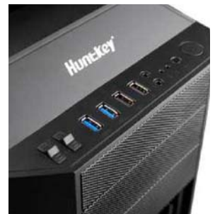
双风扇调速器,可调节前置和前置风扇的转速
