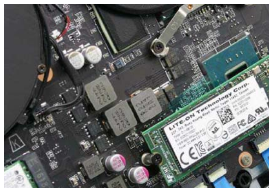
这就是与回车键相应的内部位置, 也就是 GTX 965M 显卡的供电模块, 并没有覆盖散热片很可能就是导致热量有一定堆积的原因
