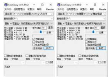
Type-C接口下实际传输速度高达324MB/s
