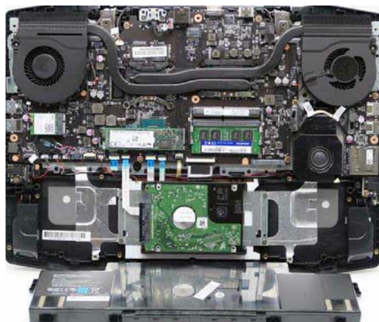
该机的维护比较容易, 拆下底盖就能进行, 但需要注意雷神是不允许玩家私自拆机的, 底部中央螺丝位覆盖了“损毁即保修无效”的贴纸。该机内部做工紧凑, 预留了 1 根内存插槽, 除此之外就没有多余的升级空间了
