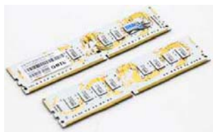
10层 PCB 外加饱满的金手指,保证了良好的稳定性和使用寿命
