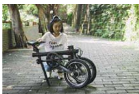
折叠后体积只能缩小到原来大小的1/3到1/2在主梁当中,主梁不能折叠,后轮的收折方式是将其从下方推到和前轮并行,通过磁铁卡扣固定。这就需要先抽出整个车座管,把后轮反转到前面之后,再将其插回去放到最低,可以支撑车身立起来。
