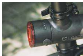
后车灯在主梁背后位置,带有电量显示和充电口,跟电池是一体的,要取出电池更换,也需要将车座管抽出
