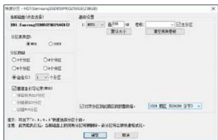
通过 DiskGenius 软件检测和设置 4K 对齐
