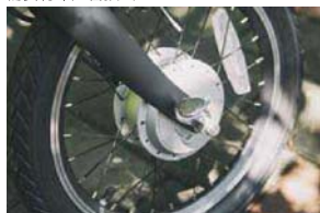
采用前轮250W电机驱动
